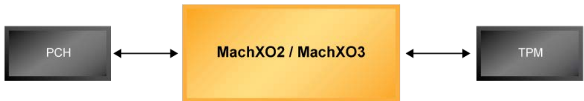
图 8：用于 TCM 的 LPC 到 SPI 桥接
